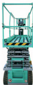
Noul design al PEA (platforma elevatoare autopropulsata) al pachetului de foarfece.
